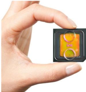
Il chip da 100Gb permette di sequenziare il genoma dell'uomo con una copertura 30X in sole tre ore
